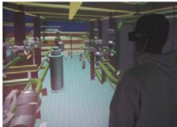
FIGURE 1.14: Visualisation du modèle 4D d'une salle d'une centrale nucléaire en environnement virtuel immersif. Image tirée de [YMBH05]
