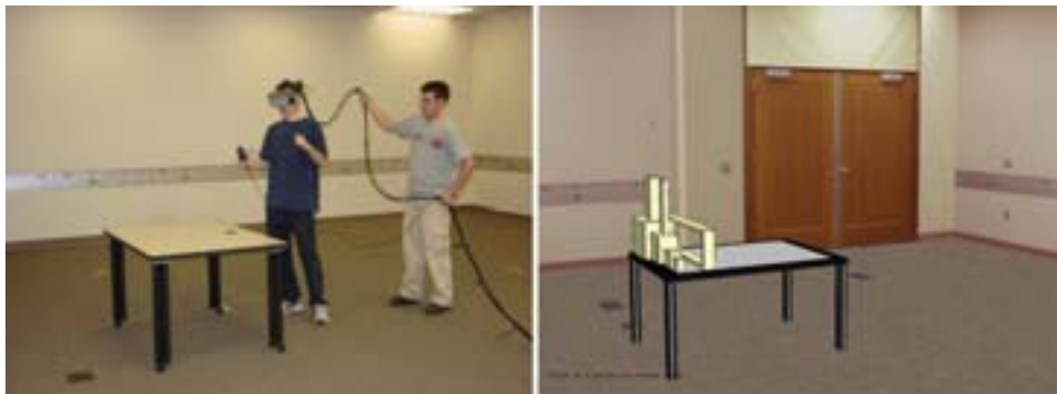
FIGURE 2.20: La figure de droite montre l'EV utilisé pour la tâche d'interaction. La figure de gauche montre la table placée dans l'environnement réel pour fournir le retour haptique. Image tirée de [IRA06].
