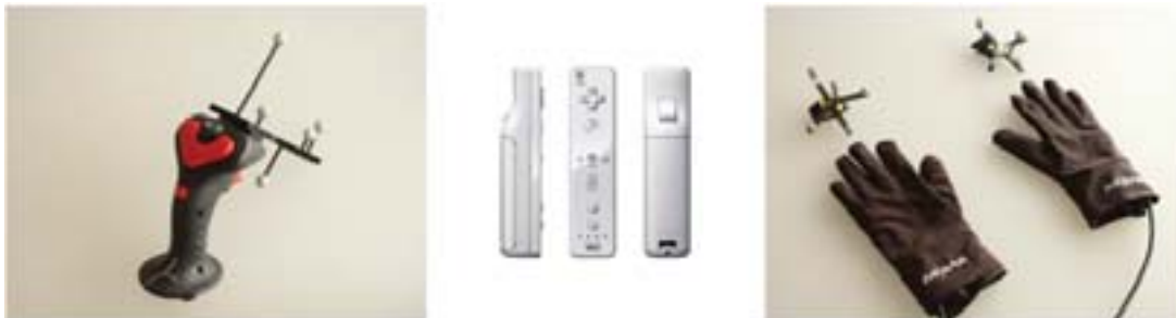
FIGURE 3.3: Les périphériques d’interaction de la plateforme de réalité virtuelle IN VIRTUO . De gauche à droite : le joystick, la Wii et les gants de données.
