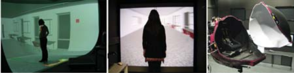
FIGURE 2.3: Exemple des écrans : écrans sphérique, grand écran plat immersif et cabine de simulation (de gauche à droite). Image tirée de [PdIRK + 13].
