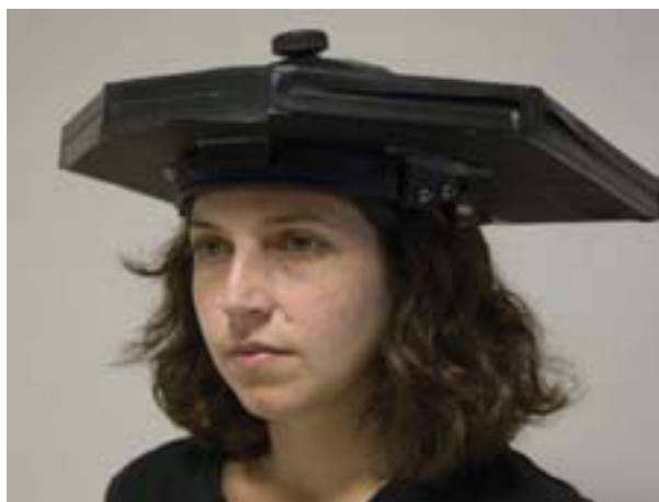
FIGURE 2.5: Casque pour simuler le poids du HMD. Image tirée de [WCCRT09].
