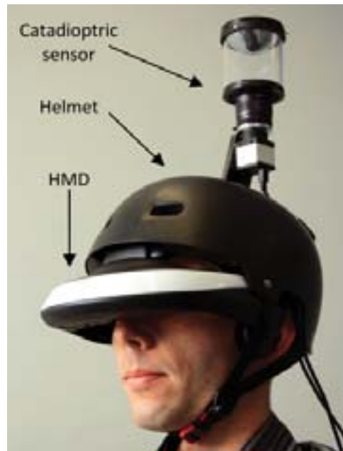
FIGURE 2.31: Le prototype du FlyViz : casque combinant un HMD et un système d’acquisition d’image. Image tirée de [ALM + 12].
