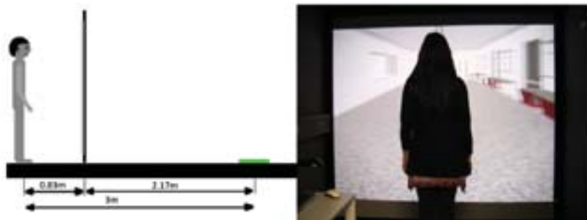
FIGURE 2.8: À gauche : image schématique de la projection avec le LSID. À droite : un utilisateur immergé en EV. Image tirée de [PdIRK + 13].
