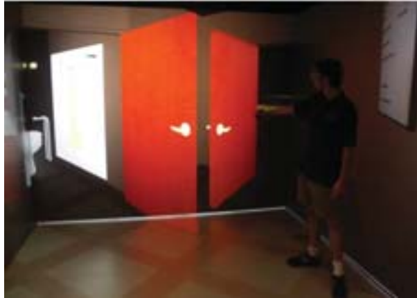
FIGURE 1.8: Exemple d'une revue de projet architectural dans un CAVE. L'utilisateur teste l'ouverture de la porte des toilettes lorsque la porte d'entrée est ouverte. Image tirée de [DAM + 07].
