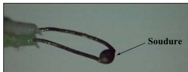
Figure 40 : Photo d'un thermocouple réalisé et étalonné à l'institut FEMTO-ST
