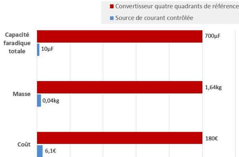
FIGURE II.43 – Comparatif du filtrage capacitifs des batteries
