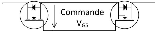
FIGURE II.25 – Interrupteur 4 segments
