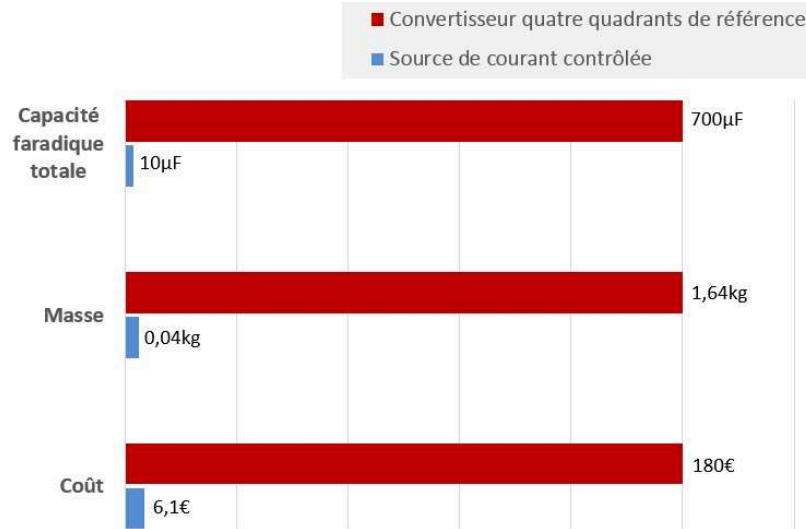
FIGURE II.43 – Comparatif du filtrage capacitifs des batteries
