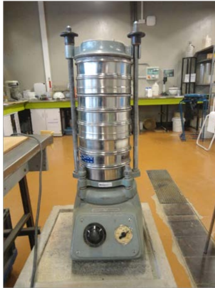
Figure 25 : Tamis vibrant utilisé pour la classification granulométrique des matériaux utilisés
