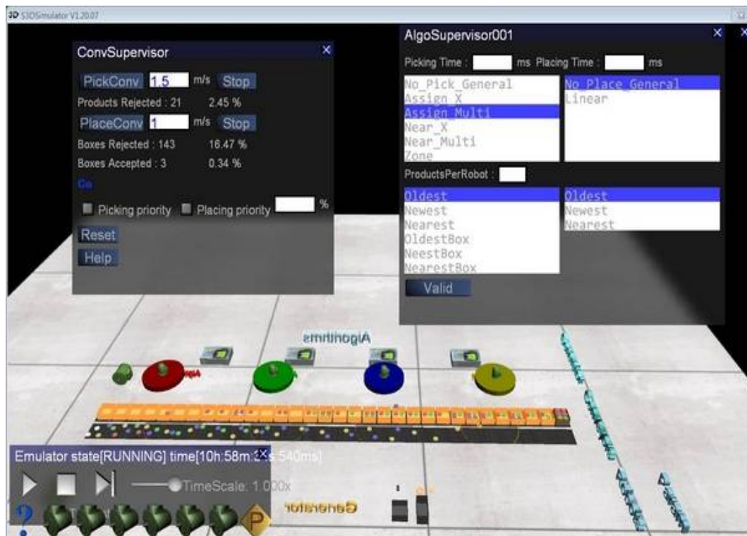
FIGURE 3.10 – Exemple de simulation avec quatre robots et deux convoyeurs co-courant.
