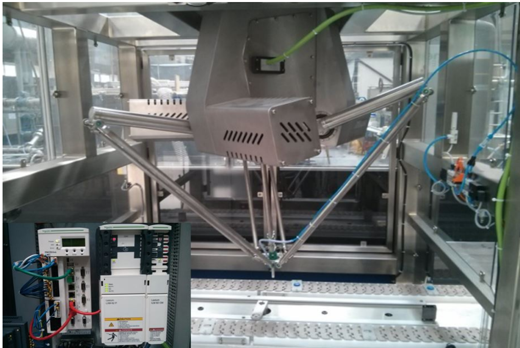
FIGURE 3.12 – Démonstrateur avec un robot et un convoyeur en anneau et un contrôleur Schneider Electric LMC400C.
