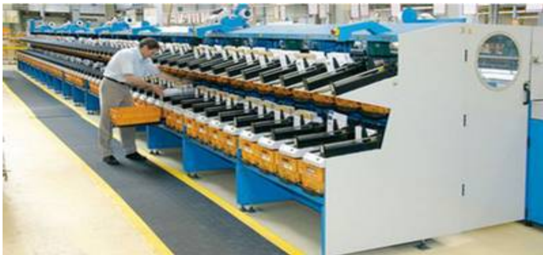
FIGURE 3.4 – Exemple de machine de tri postal conçue par Solystic.
