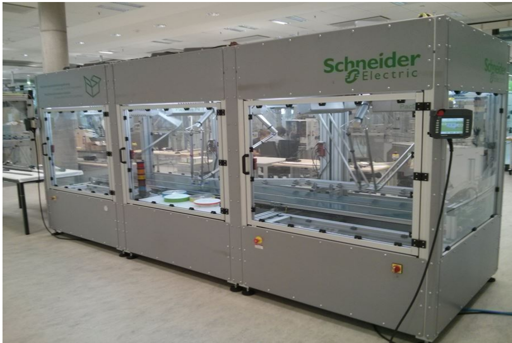
FIGURE 3.13 – Démonstrateur avec trois robots et deux convoyeurs parallèles.
