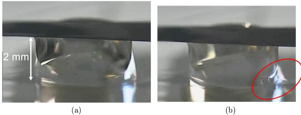
FIGURE 4.10 – Visualisation d'une goutte en contact avec une membrane (a) au repos (b) actionnée.
