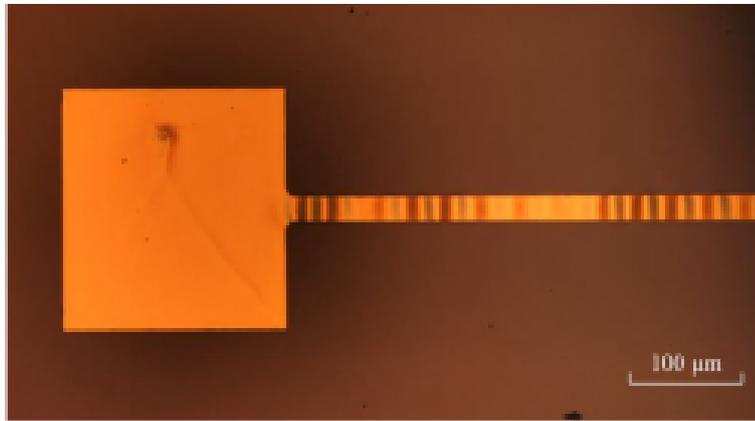
FIGURE 2.25 – Photographie d'une ligne fabriquée. Les ondulations sont dues à la dilatation thermique du PDMS.
