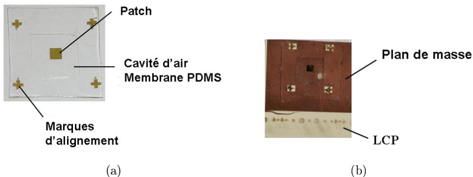
FIGURE 3.19 – Photographies d'échantillons fabriqués (a) Partie PDMS uniquement (b) Dispositif complet.
