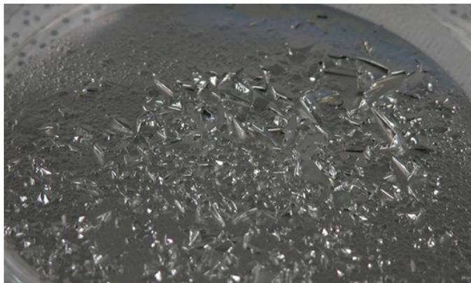
FIGURE 2.20 – Essais de métallisation directe par pulvérisation cathodique RF d'aluminium sur du PDMS
