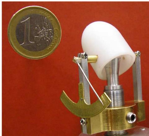
FIGURE 1.16 – Antenne à lentille orientable – Source : Costa *et al.* [69]
