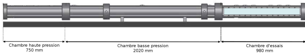
FIGURE 5.1 – Tube à choc T80 du laboratoire IUSTI de Marseille.
