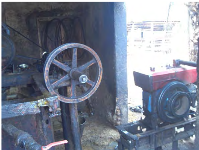
Photo 26. Une unité de transformation semi industrielle munie d'un moteur électrogène (située à 5 km de Rumonge sur les rives de la rivière Dama)
