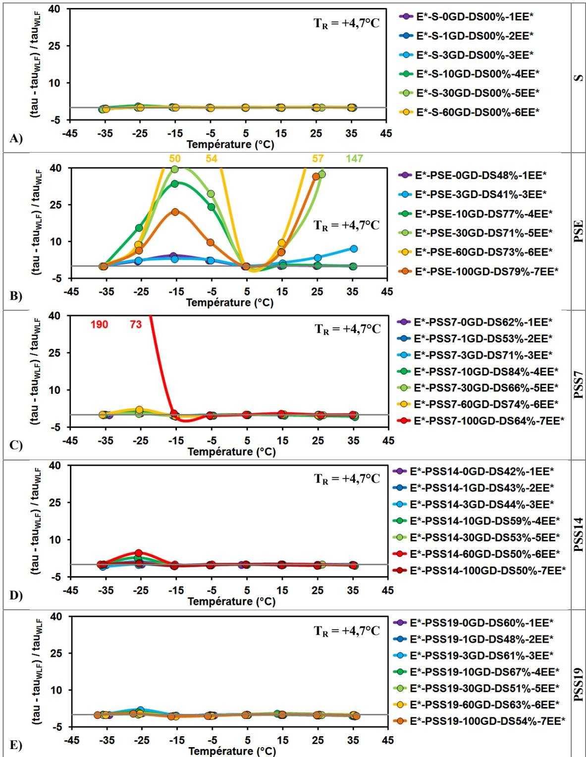
Figure 4.37 Delta tau sur tau<sub>WLF</sub> en fonction de la température pour les cinq états étudiés et EE\* réalisés (paramètres 2S2P1D fixés et constantes WLF déterminés à T<sub>R</sub> = +4,7°C)
