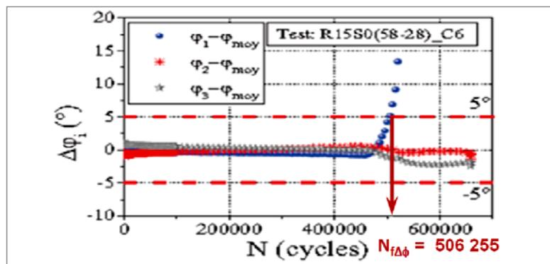
Figure 1.16 Écart d'angle de phase et détermination de  $N_{f\Delta\phi}$
