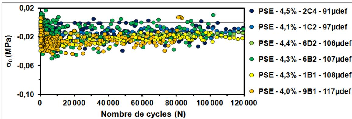
Figure 5.17 Évolution de la valeur centrée de contrainte pour les éprouvettes à l'état partiellement saturé en eau, sans jauges et ayant une teneur en vides intermédiaire
