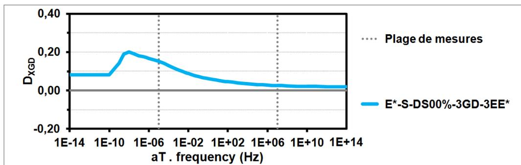
Figure 4.16 Variation du dommage en fonction de la fréquence équivalente ( $aT \cdot Fr$ ) calculée suivant le 2<sup>ème</sup> ET, soit au 3<sup>ème</sup> EE\* ( $D_{XGD}$ ) ( $T_R = -5,5^\circ\text{C}$ )
