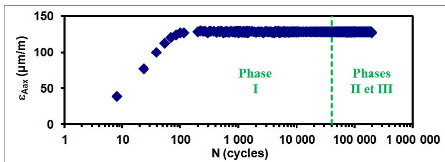
Figure 5.4 Évolution de l'amplitude de déformation axiale moyenne
