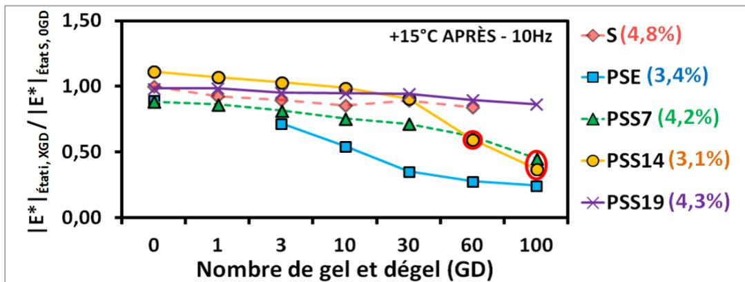
Figure-A VII-4 Normalisation de la norme du module complexe ( $|E^*|$ ) à +15°C APRÈS et 10Hz à l'état i et à X GD par rapport à celle obtenue pour l'enrobé à l'état sec (S) et à 0 GD (mesures des extensomètres)
