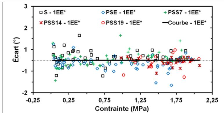
Figure 2.21 Écart entre extensomètres et jauges pour l'angle de phase ( $\phi_E$ ) en fonction de la contrainte après correction
