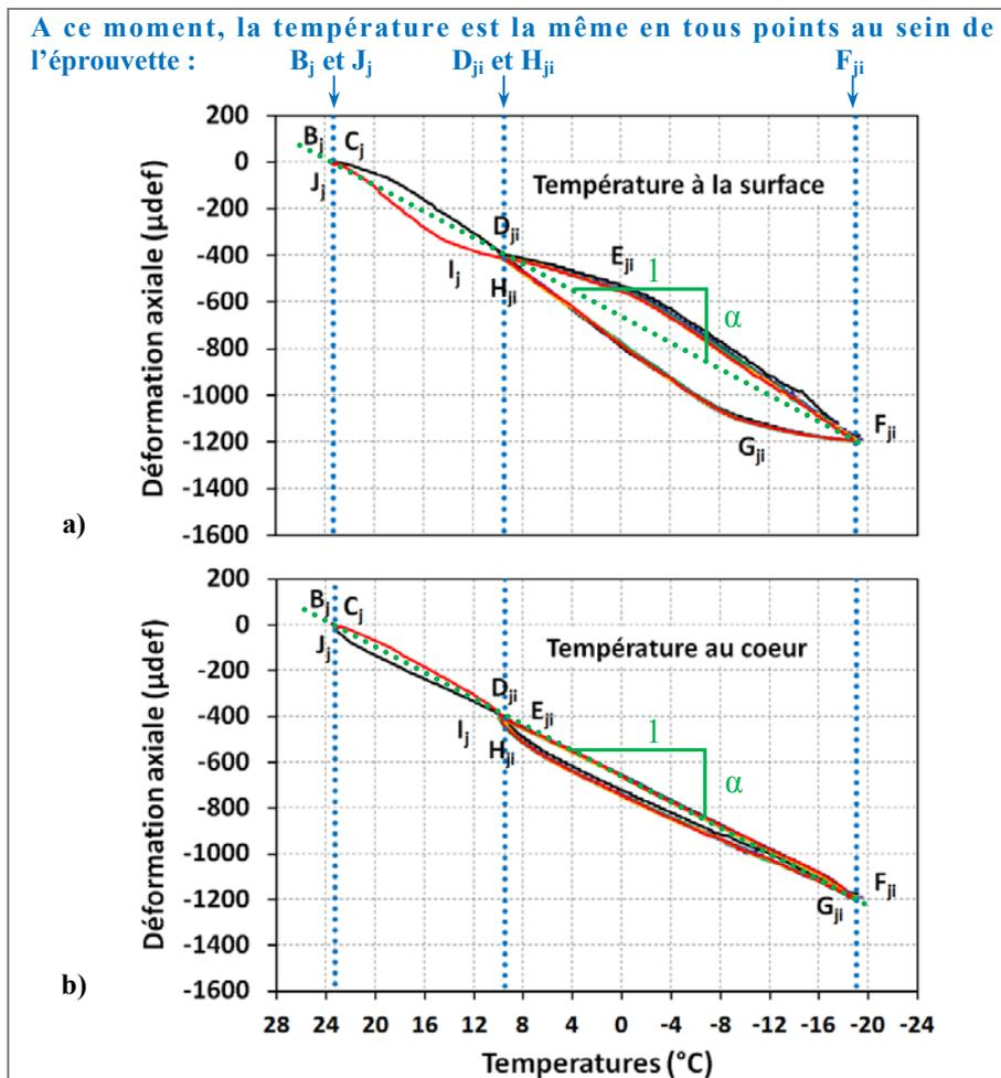
Figure 3.13 a)  $\epsilon_{axiale}$  vs  $T_{surface}$ , b)  $\epsilon_{axiale}$  vs  $T_{cœur}$  pour l'éprouvette PSS7 ( $58 \leq DS \leq 61\%$  ;  $B_j$  à  $J_j$  définis à la Figure 2.9 ;  $j = 3 ; 4 \leq i \leq 10$ )
