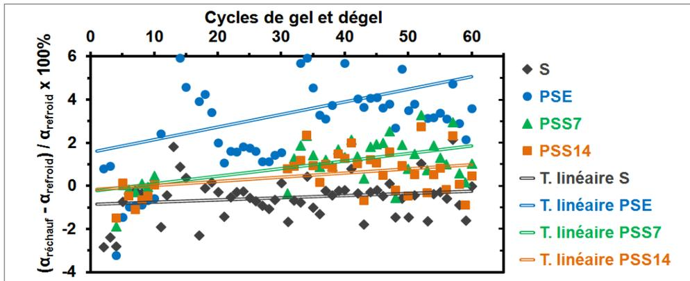
Figure 3.17 Évolution du rapport entre le coefficient de dilatation linéique lors du réchauffement ( $\uparrow T$ ,  $\alpha_{\text{réchauf}}$ ) et celui lors du refroidissement ( $\downarrow T$ ,  $\alpha_{\text{refroid}}$ ) lors d'un même cycle de GD pour la plage de température de  $-18$  à  $+10^{\circ}\text{C}$
