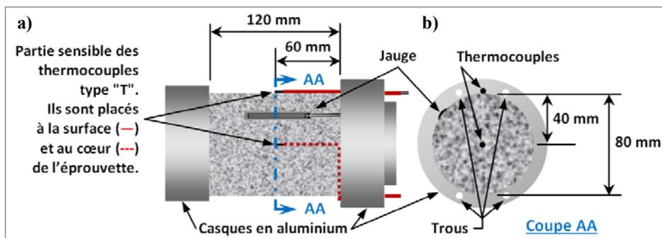
Figure 2.5 Instrumentation des éprouvettes de type T :
