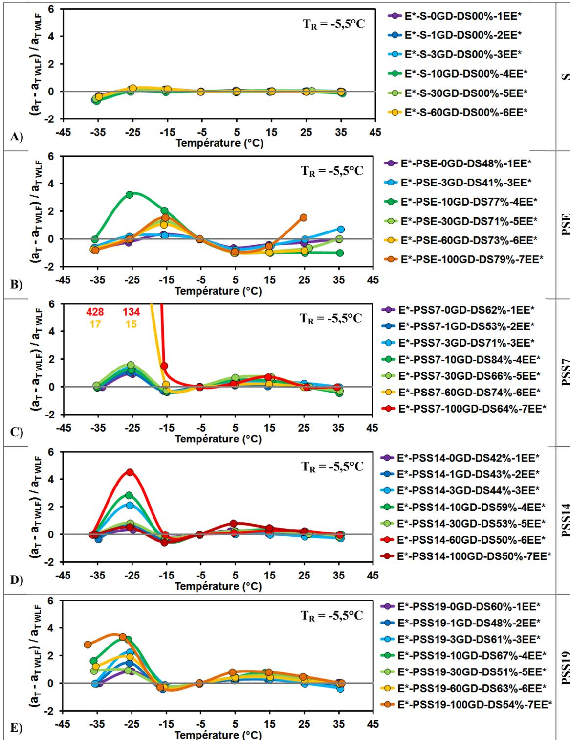
Figure 4.36 Delta  $a_T$  tau sur  $a_{T,WLF}$  en fonction de la température pour les cinq états étudiés et  $EE^*$  réalisés (paramètres 2S2P1D fixés et constantes WLF déterminés à  $T_R = -5,5^\circ\text{C}$ )
