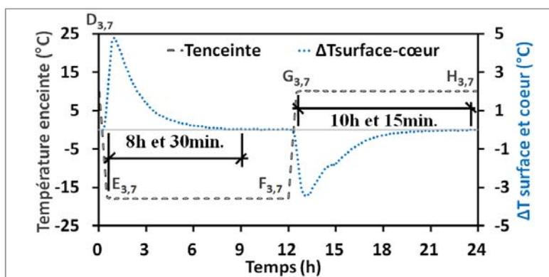
Figure 3.4 Différence de température entre la surface et le cœur de l'éprouvette S lors du 7<sup>ème</sup> cycle GD (3<sup>ème</sup> ET)
