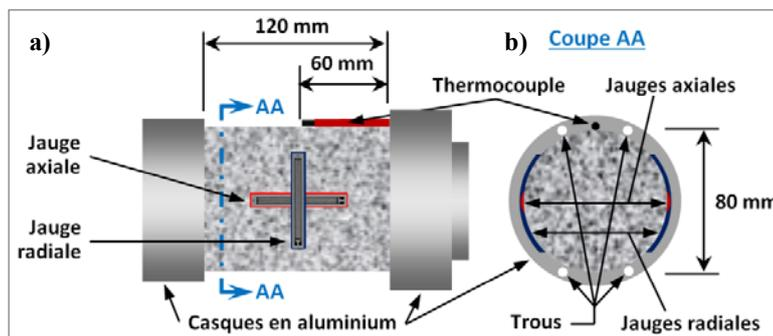
Figure 2.6 Instrumentation des éprouvettes de type  $E^*$  :
