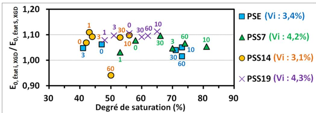
Figure 4.47 Normalisation de la valeur d' $E_0$  de l'enrobé bitumineux à l'état  $i$  et à  $X$  GD par rapport à celle obtenue pour l'enrobé à l'état sec (S) et à  $X$  GD (paramètres fixés pour le modèle 2S2P1D et numéro du CGD en étiquette)
