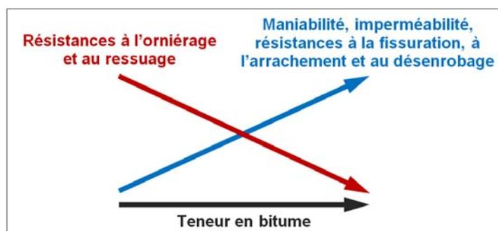
Figure 1.1 Teneur en bitume et propriétés de l'enrobé
