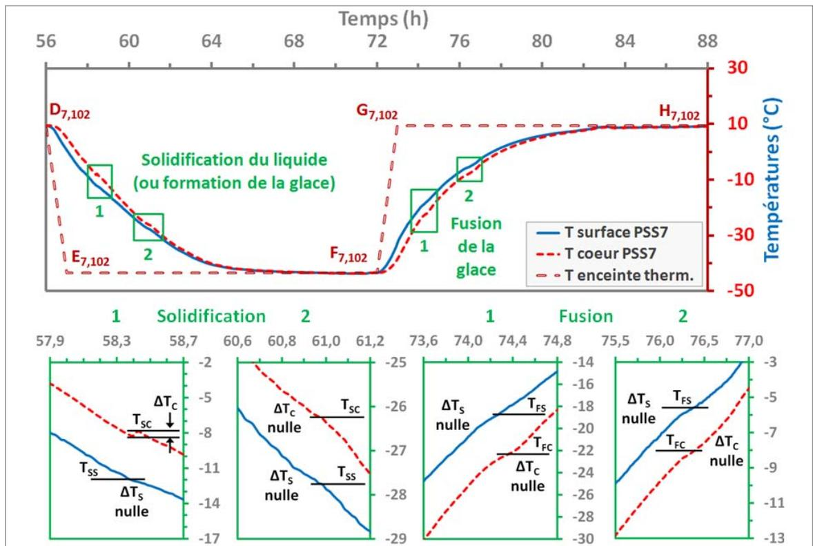
Figure 3.21 Températures à la surface et au cœur de l'éprouvette PSS7 lors du 102<sup>ème</sup> cycle de GD, et détermination des variations de température ( $\Delta T_s$  et  $\Delta T_c$ ) lors de la formation de la glace à la surface ( $T_{ss}$ ) et au cœur ( $T_{sc}$ ) ou à sa fusion à la surface ( $T_{fs}$ ) et au cœur ( $T_{fc}$ )
