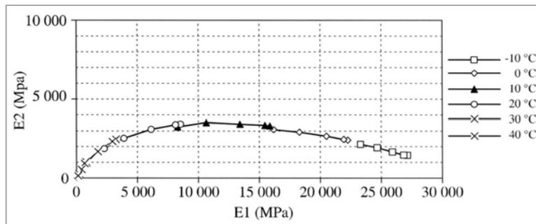
Figure 1.9 Module complexe dans le plan Cole et Cole
