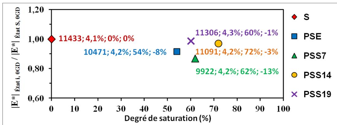
Figure-A VII-2 Normalisation de la valeur de  $|E^*|$  à +15°C AVANT-10Hz de l'enrobé à l'état i et à 0 GD par rapport à celle de l'enrobé à l'état sec et à 0 GD (mesures des jauges) en fonction du degré de saturation (valeurs de  $|E^*|$ , teneur en vides, degré de saturation et écart en % de  $|E^*|$  par rapport à l'état sec indiquées)
