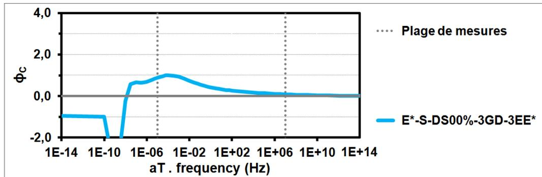
Figure 4.17 Variation du phi en fonction de la fréquence équivalente ( $aT \cdot Fr$ ) calculée suivant le 2<sup>ème</sup> ET, soit au 3<sup>ème</sup> EE\* ( $\phi_c$ ) ( $T_R = -5,5^\circ\text{C}$ )
