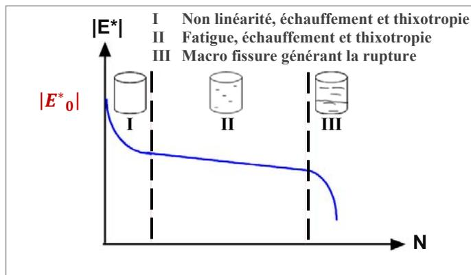
Figure 1.12 Évolution de la rigidité de l'éprouvette suivant trois phases lors d'un essai de fatigue
