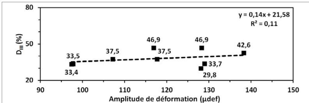
Figure 5.28 Niveau de dommage menant à la rupture ( $D_{III}$ ) pour les éprouvettes à l'état sec, testées à  $+10^{\circ}\text{C}$  et 10Hz, en fonction de l'amplitude de déformation
