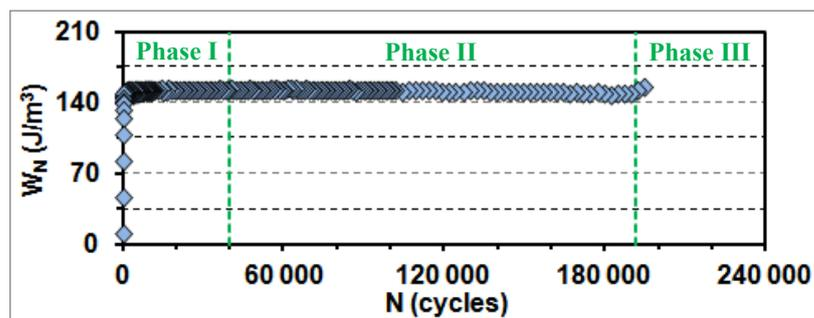
Figure 5.11 Évolution de l'énergie dissipée par cycle ( $W_N$ )
