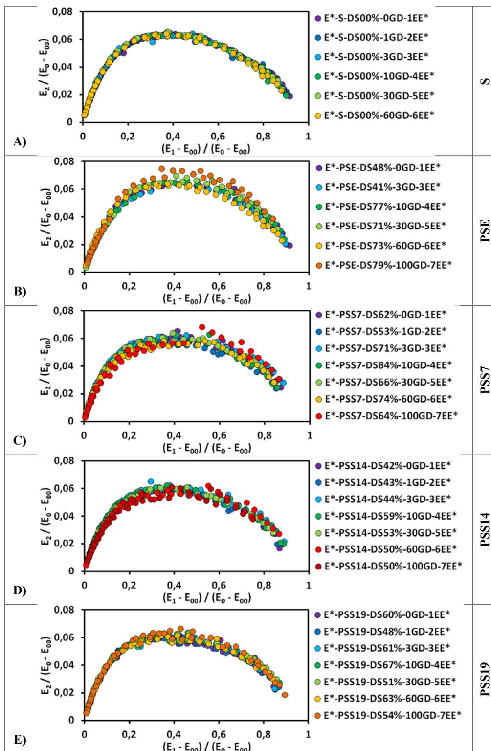
Figure 4.24 Plan de Cole-Cole normalisé suivant les ET et les EE\* pour les cinq états étudiés
