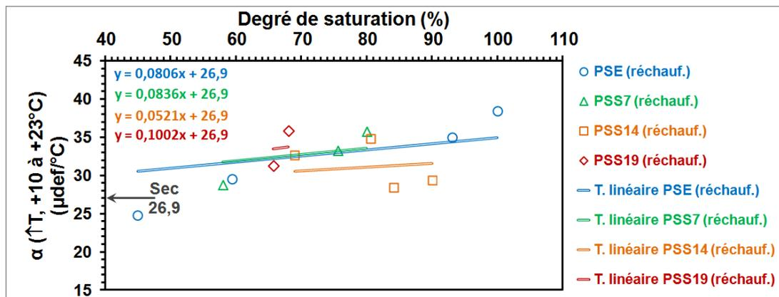
Figure 3.16 Coefficients de dilatation linéique ( $\alpha$ ) lors du réchauffement ( $\uparrow T$ ) pour toutes les éprouvettes partiellement saturées entre +10 et +23°C en fonction du degré de saturation (valeur à l'ordonnée de 26,9 pour les courbes de tendance linéaire)
