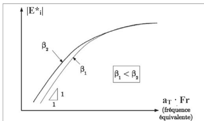
Figure 4.10 Détermination de la constante  $\beta$  à partir de la courbe maîtresse du module complexe
