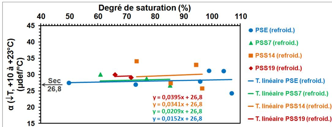
Figure 3.15 Coefficients de dilatation linéique ( $\alpha$ ) lors du refroidissement ( $\downarrow T$ ) pour toutes les éprouvettes partiellement saturées entre +10 et +23°C en fonction du degré de saturation (valeur à l'ordonnée de 26,8 pour les courbes de tendance linéaire)
