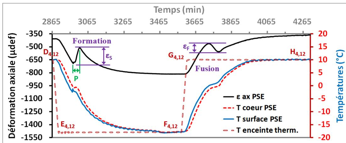
Figure 3.10 Déformation axiale ( $\epsilon_{axiale}$ ) et températures dans l'enceinte, à la surface et au cœur de l'éprouvette PSE lors du 12<sup>ème</sup> CGD, et détermination de la dilatation générée lors de la formation de la glace ( $\epsilon_S$ ) et de la contraction liée à sa fusion ( $\epsilon_F$ )
