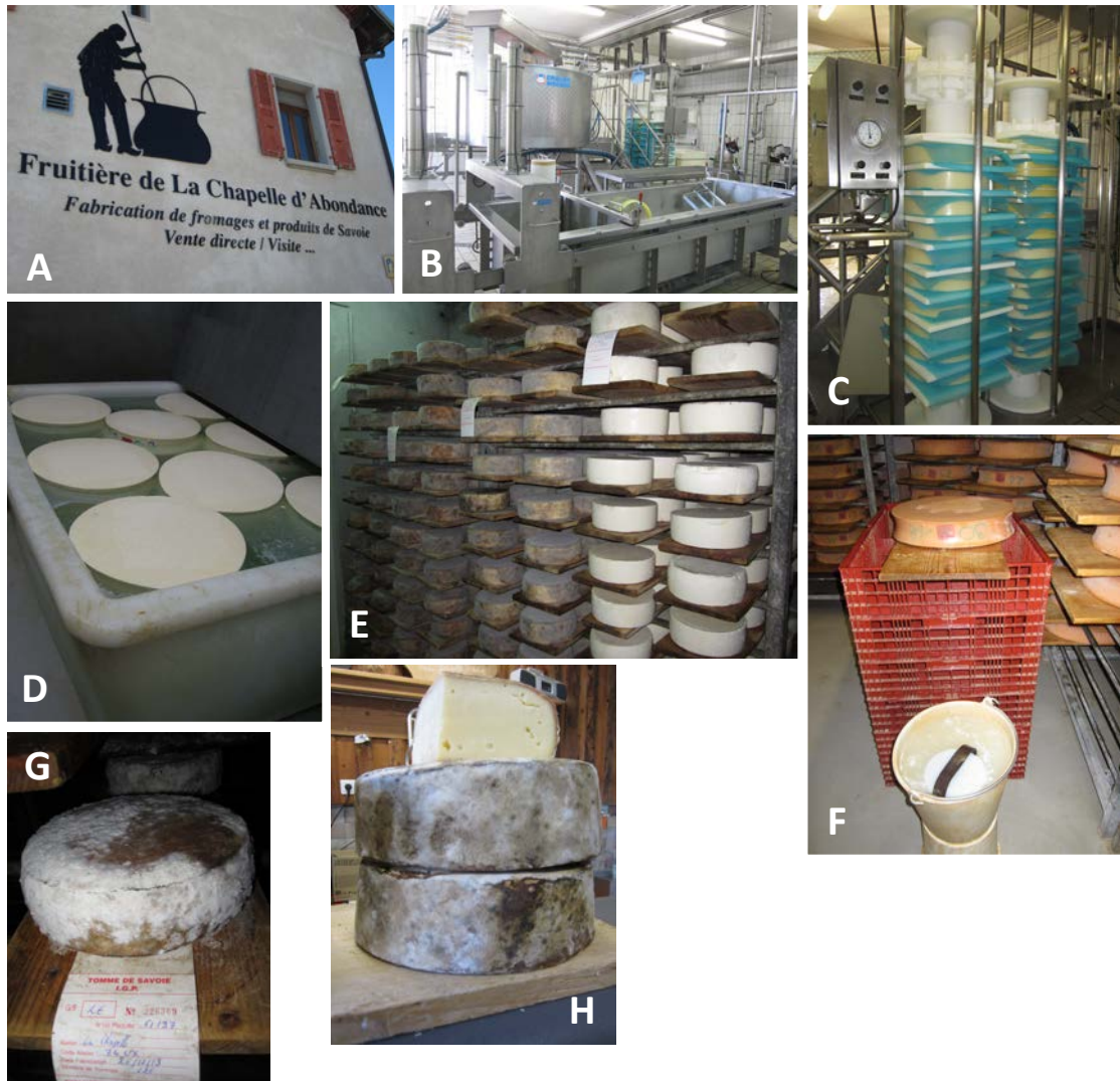
Figure 10 : Illustration du processus de fabrication du fromage. A. Fruitière de la Chapelle d'Abondance. B. Cuves d'emprésurage et de coagulation. C. Egouttage - pressage. D. Salage. E. Affinage. F. Nettoyage de surface (Abondance). G et H. Tommes de Savoie affinées. (Photos Morin-Sardin ; Fruitière de la Chapelle d'Abondance).
