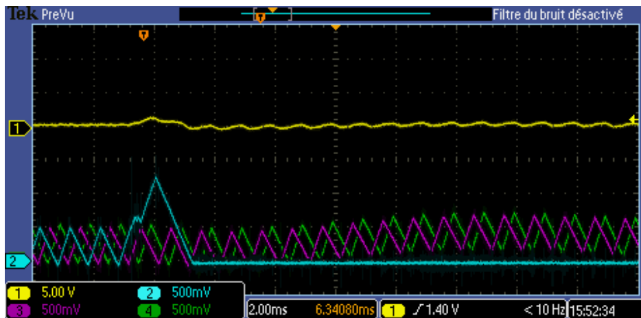
Fig. 5. 38: Performances de l'algorithme pour des défauts de court-circuit, D=0.5 Voie 1 : courant PàC [100A/div], Voie 2 : courant phase 1 [50A/div], Voie 3 : courant phase 2 [50A/div], Voie 4 : courant phase 3 [50A/div].
