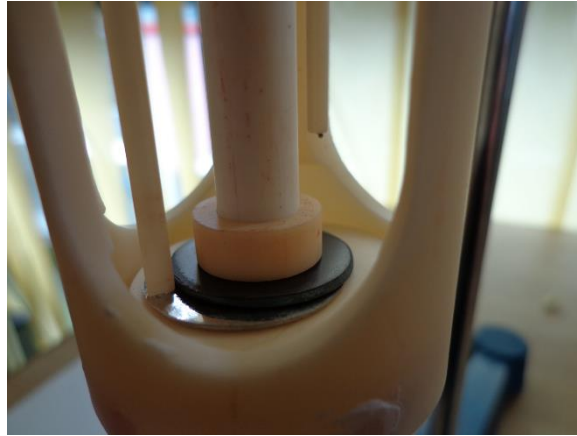
Figure 34 : Cellule de mesure pour les tests d'impédance électrochimique.
