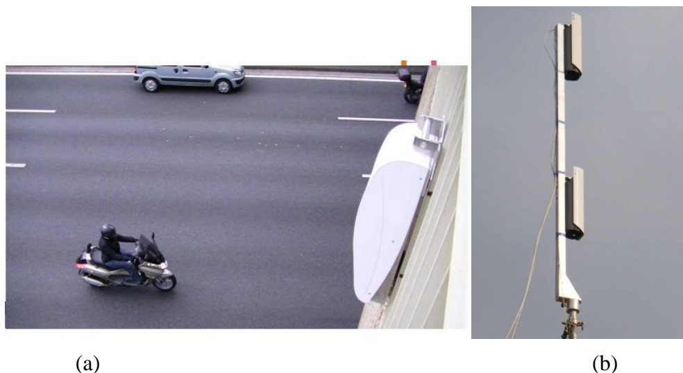
Figure V.10: Capteurs vidéo : a) mono-caméra (Néavia), b) stéréoscopique (Ifsttar)
