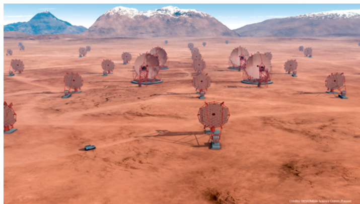
Figure 4.2 – Vue d’artiste d’un groupe de télescopes du réseau CTA, répartis sur deux sites : nord (île des Canaries La Palma en Espagne) et sud (Paranal dans le désert d’Atacama au Chili), afin de couvrir l’intégralité du ciel. Ces télescopes mesurent la lumière Cherenkov d’une gerbe de particules afin de déterminer la direction incidente et l’énergie du photon THE l’ayant provoquée. Crédits : DESY/Milde Science Comm./Exozet.
