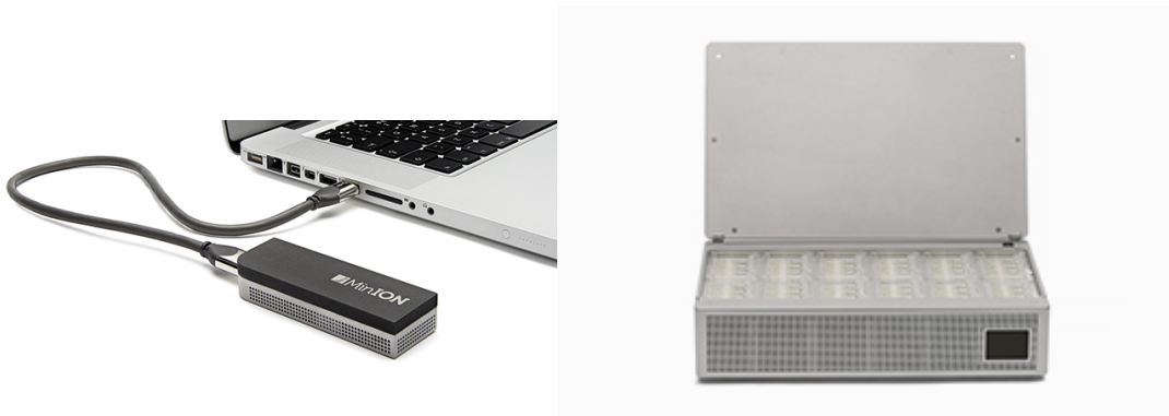
FIGURE 1.10 – Les appareils de séquençage, MinION et PromethION de la société Oxford Nanopore Technologies [77].
