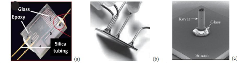
FIGURE 1.24: Différents types de packaging pour permettre les injections de fluides au sein du milieu poreux. (a) Tubes capillaires collés avec une colle époxy. (b) Tubes en métal soudés. (c) Tube de Kovar soudé au verre sur du silicium.
