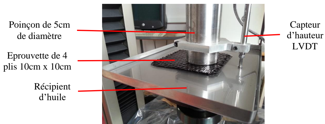
Figure 4-2 : Mesure de compressibilité de préforme lubrifiée
