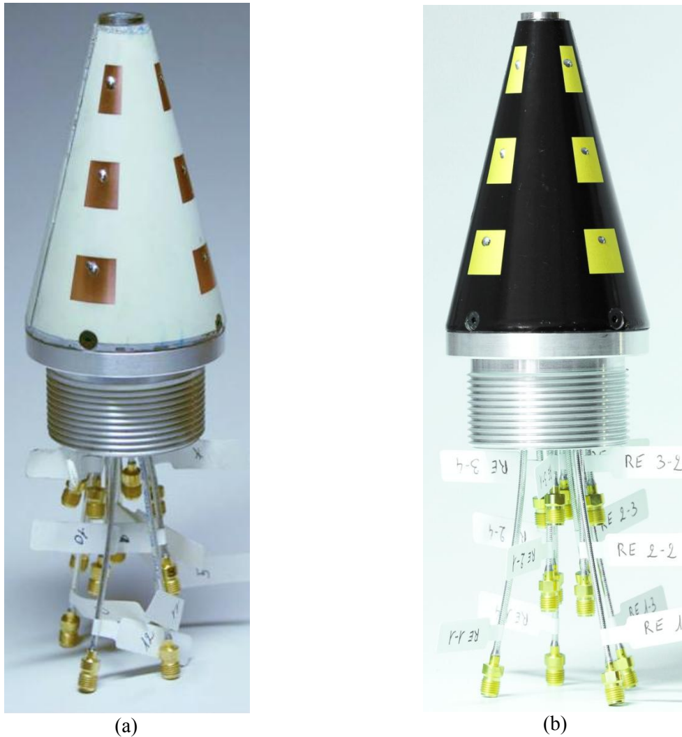
Figure 4-5 : Prototypes de l'antenne (a) fabriqué à l'ISL et (b) en technologie LDS.
