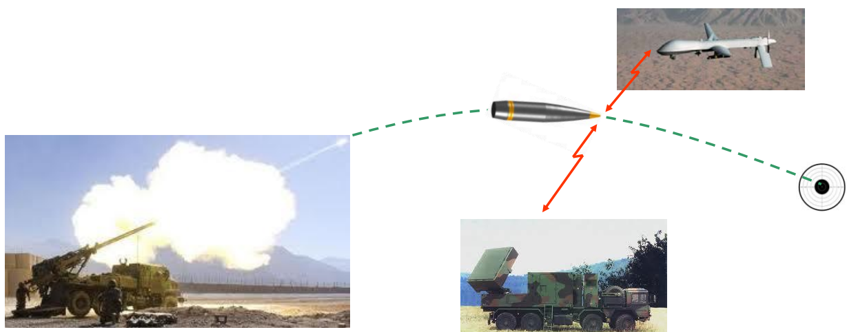
Figure 1 : Scénario de communication entre un projectile, un système en vol et une station au sol.
