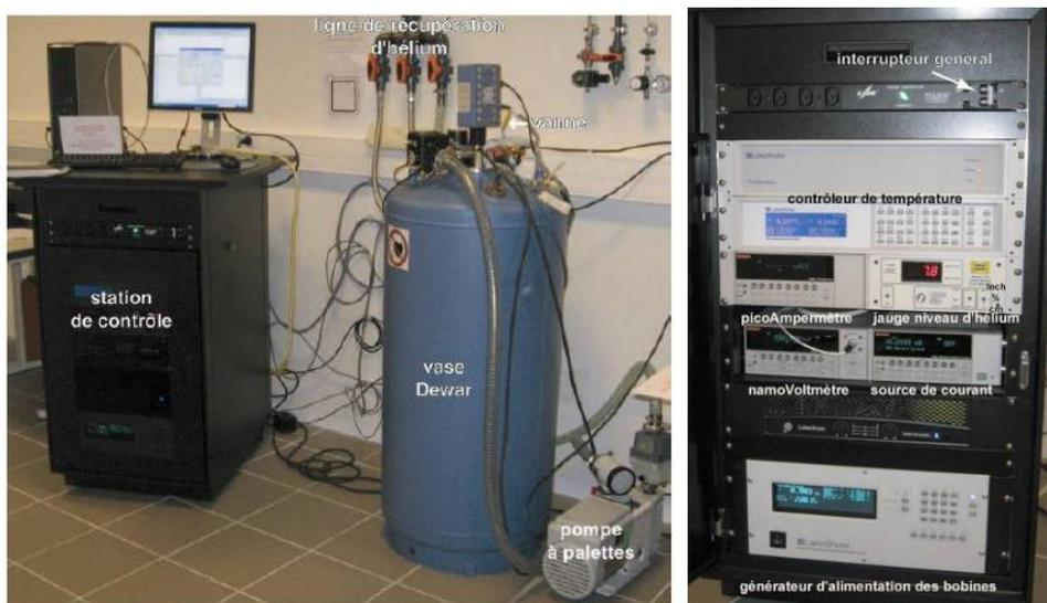
Figure II.19. Photos de station Cryogénique 9T. Banc de caractérisation magnétorésistance [Mescot 09].
