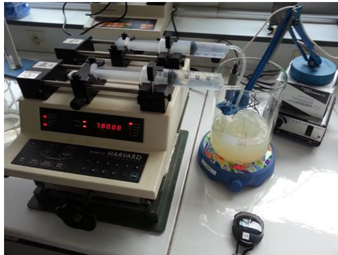
Figure III – 11 Photo du dispositif expérimental permettant la synthèse du composé illite/FeH
