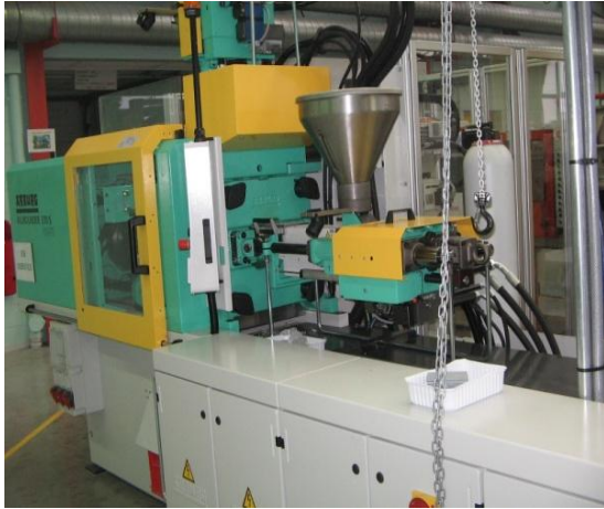
Photo 38 : Presse à Injecter
