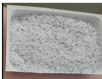
Photo 18 : Résidus de polystyrène broyé
