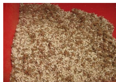
Photo 19 : Mélange de polystyrène et des coques de cotonnier broyé
