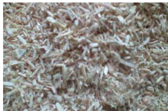
Photo 10.a) : Bois de kénaf hachés (5 à 15 cm) photo10.b) : Broyat de kénaf (0 à 5 mm)
