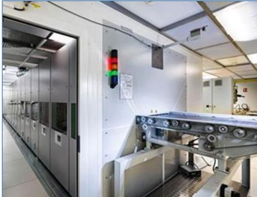
Figure 2-15: Photographie du four de recuit pour substrat 60x120 cm<sup>2</sup>.
