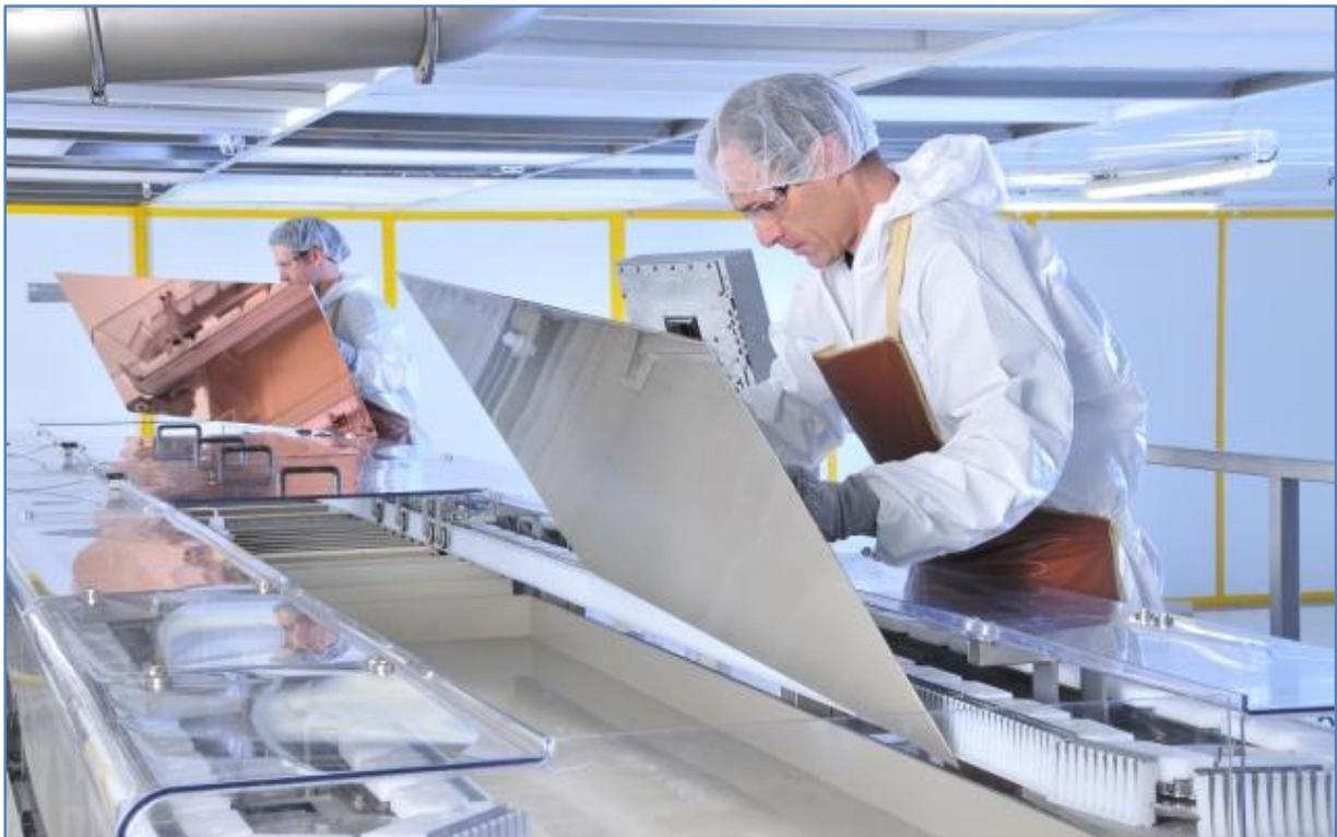
Figure 2-5: Photographie de l'équipement d'électrodéposition du précurseur métallique sur substrat de taille 60x120cm<sup>2</sup> (ligne pilote Nexcis).
