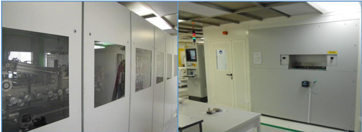
Figure 2-17: Photographies du four de recuit pour substrat de taille 30x60 cm<sup>2</sup>.
