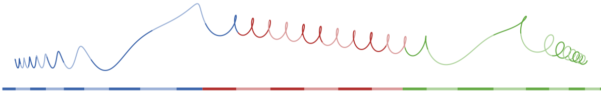
FIGURE 4.2.38 : Trois éléments de Clothoïde 3D raccordés avec une continuité \mathcal{C}^2 . L'alternance clair/foncé indique les découpes de notre algorithme de stabilisation pour le calcul par série entière. Le découpage est plus fréquent dans les régions fortement courbées et il est uniforme pour l'élément central (en rouge) qui est une hélice circulaire 17 .
