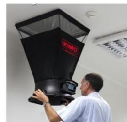
Figure 35 - Cône de mesure des débits de soufflage pour les bouches à jets hélicoïdal
