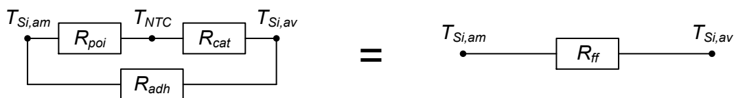
Figure 4-21. Schéma des résistances thermiques des échantillons G1-Co-6 , G1-CP-11 et G1-CP-12 . Pour plus de clarté, les résistances thermiques associées à la peinture sont négligées et les capacités thermiques ne sont pas représentées.
