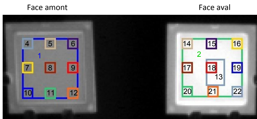
Figure 3-12. Disposition des zones de mesure IR en face amont (n° 1 et 4 à 12) et aval (n° 2 et 13 à 22) de G3-oo-7 et G3-Co-9 .
