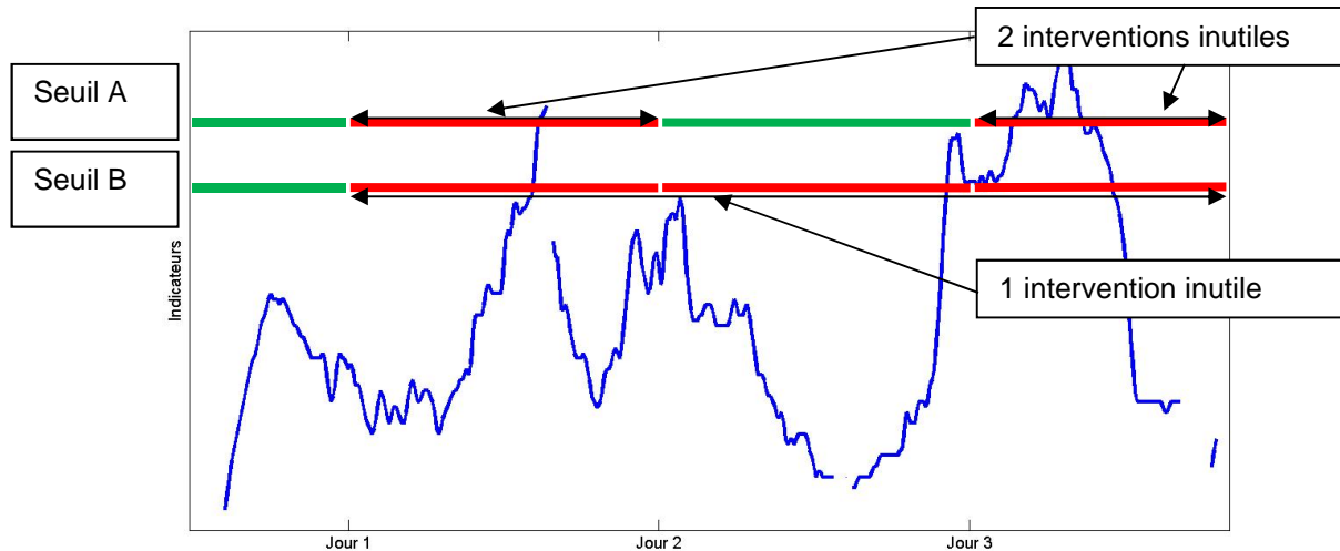
Figure 5.2 Schéma de principe d'une période de fausses alarmes avec un indicateur dans une période sans défaut
