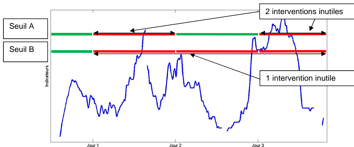
Figure 5.2 Schéma de principe d'une période de fausses alarmes avec un indicateur dans une période sans défaut
