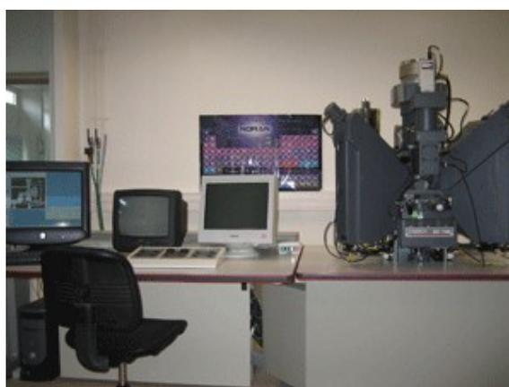
**Figure II-15 : Microsonde de Castaing SX100 du SCMEM**
