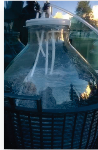
Figure 25 : Diffusion des bulles d'ozone dans le réacteur
