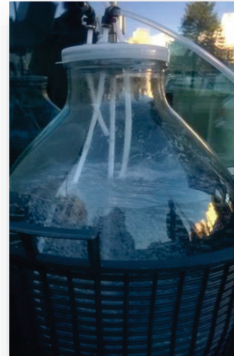
Figure 25 : Diffusion des bulles d'ozone dans le réacteur
