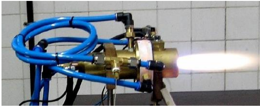
Figure 2.20 – Torche à plasma en fonctionnement.
