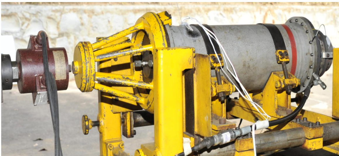
Figure 2.10 – Capteur de pression installé sur le joint arrière du moteur test.
