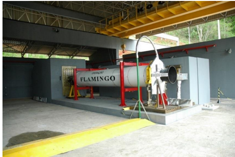
Figure 2.18 – Moteur échelle un intégré sur le banc d’essais avant l’ignition.
