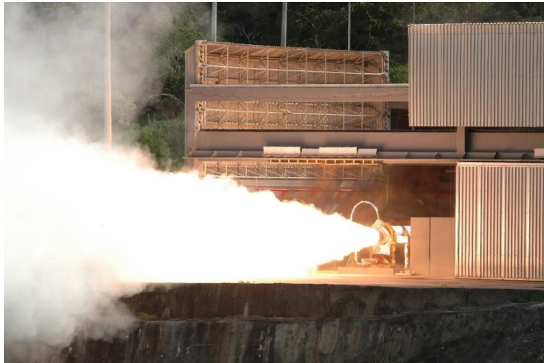
Figure 5.13 – Fonctionnement du moteur S43 au banc d’essais.
