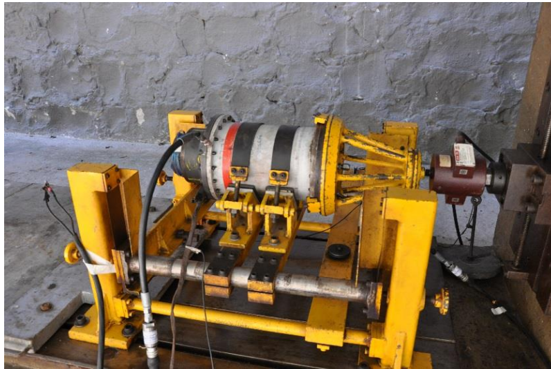
Figure 5.2 – Positionnement du moteur test au banc d'essais.
