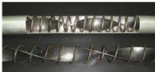
Figure I-48 : Exemples d'association de mélangeurs statiques et de fils spiralés (Promvongse, 2008)
