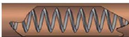
Figure I-45: Exemple de fil spiralé triangulaire inséré dans un tube (Gunes, et al., 2010)
