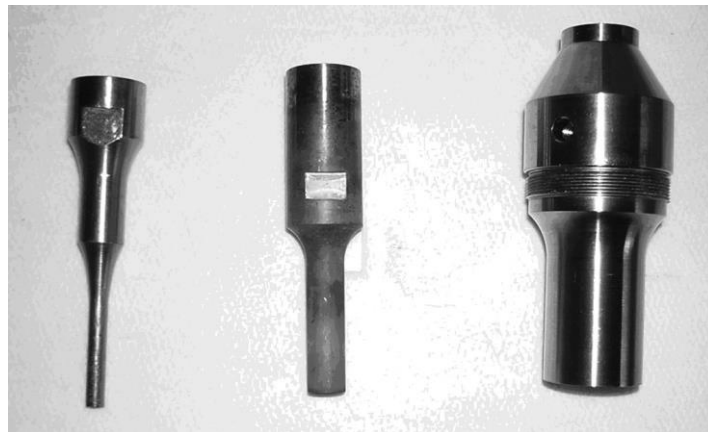
Figure I-21: Exemples de sondes métalliques qu'il est possible de coupler avec un assemblage piézoélectrique triplet. Plus les sondes sont effilées et plus l'intensité acoustique I [W.m^{-2}] peut être localement importante (Petrier, et al., 2008)
