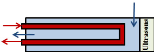
Figure I-88 : Configuration tube et calandre avec transducteur ultrasonore à une extrémité (Yao, et al., 2010). Les flèches indiquent le sens des écoulements
