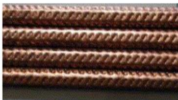
Figure I-52 : Exemple de tubes emboutis en chevrons (Meng, et al., 2005)
