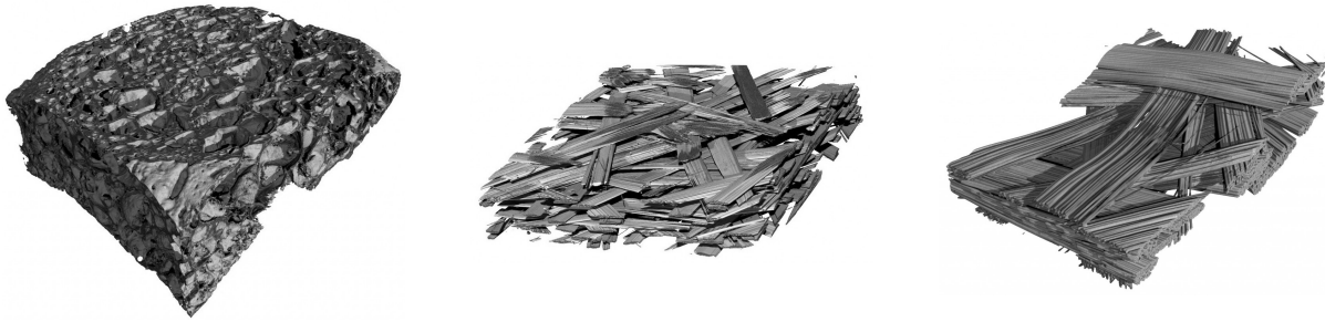
Figure 1.14 – Exemple de reconstruction de milieux poreux par tomographie. Visualisation de l'espace poral permettant la détermination des caractéristiques du milieu poreux.
