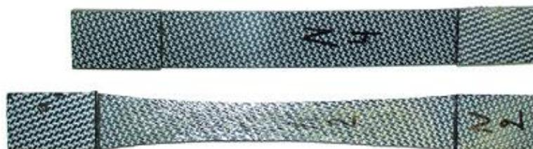
Figure 1.25 : Eprouvettes  $[(\pm 45)_{4S}]$  avant et après essais en fatigue [De Baere et al., 2011a]
