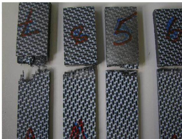
Figure 1.20 : Localisation de la rupture pour un composite tissé carbone/PPS (satin de 5) lors d'un essai de fatigue traction-traction [Daggumati et al., 2013].
