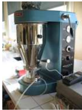
Figure 6 : Lit d'air fluidisé (Aeromatic Strea 1) (Unité Inserm and Université de Lille 2, 2015).
