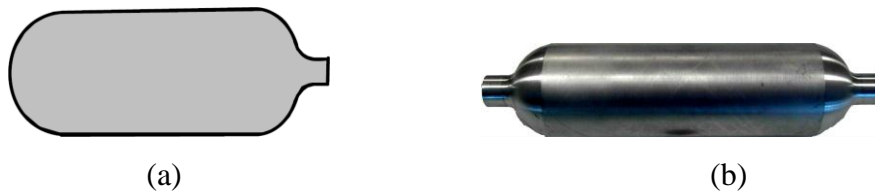
Figure 2 : Illustrations du 4 ème type des réservoirs : (a) schéma et (b) photographie
