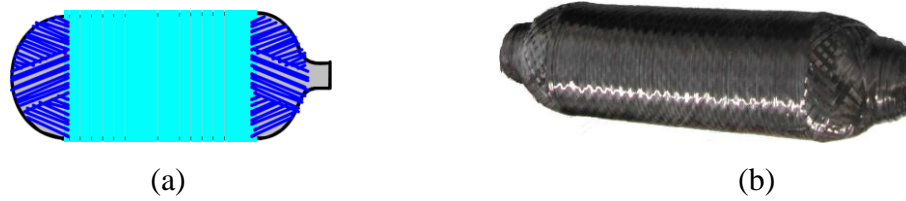
Figure 4 : Illustrations du 3 ème type des réservoirs : (a) schéma et (b) photographie
