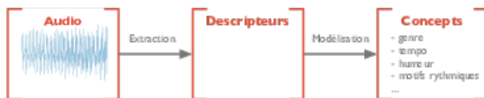
FIGURE 2.2 – Système d'analyse automatique de la musique. Il se compose en général d'une étape d'extraction de descripteurs à partir du signal audio, et d'une étape de modélisation des concepts haut-niveaux.
