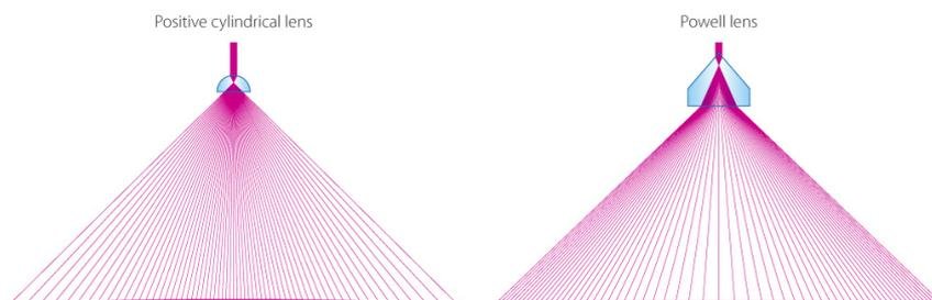
FIGURE 2.7 – Diagramme de comparaison d’une lentille cylindrique classique (gauche) avec une lentille *Powell* (droite). La première transmet le caractère gaussien du faisceau alors que la seconde crée un profil d’éclairage homogène. (source <http://www.altechna.com>)
