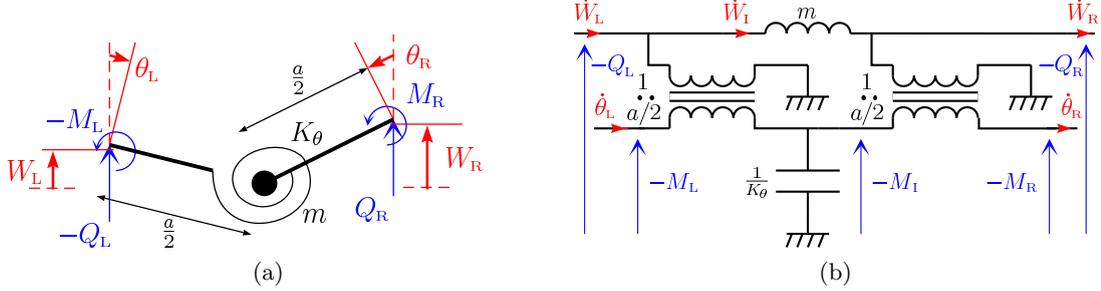
Figure 13: Cellules élémentaires pour la propagation transversale: (a) Portion de poutre discrétisée. (b) Analogue électrique d'une portion de poutre.
