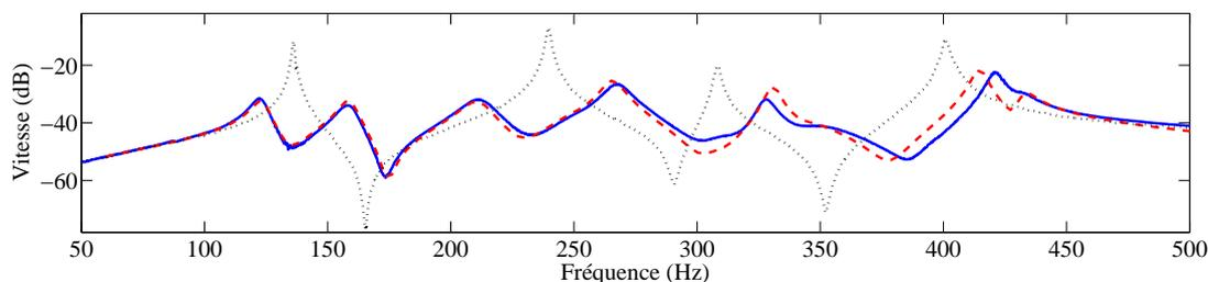
Figure 22: Effet du couplage au réseau analogue sur la réponse vibratoire de la plaque - ( $\cdots$ ) réponse expérimentale en court-circuit, ( $—$ ) réponse expérimentale pour  $L=0.9$  H et  $R_s^+=0$   $\Omega$ , ( $- -$ ) réponse simulée pour  $L=0.9$  H et  $R_s^+=0$   $\Omega$ .
