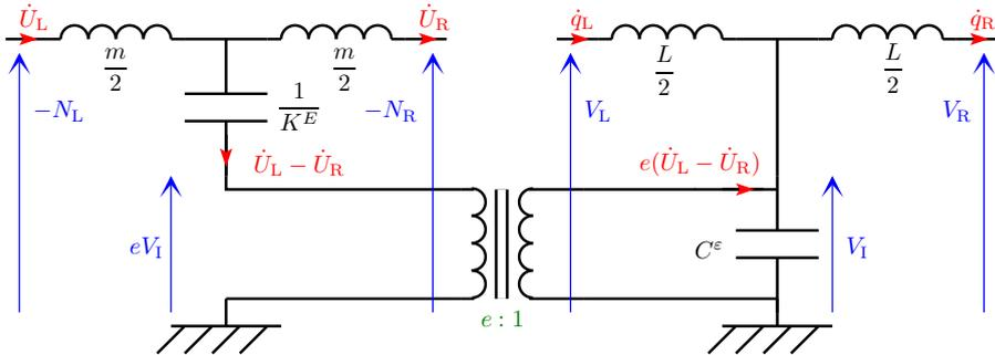
Figure 8: Modèle discret de la cellule élémentaire électromécanique.
