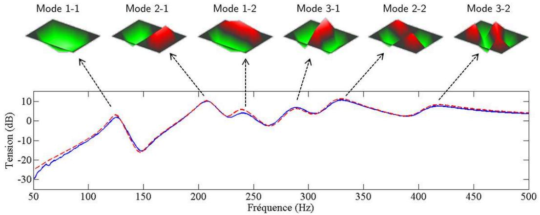
Figure 20: Distributions spatiales du courant et fonctions de réponse en fréquence pour la tension aux bornes d'une inductance avec  $L = 0.9$  H et  $C = 470$  nF - (—) réponse expérimentale, (---) réponse simulée.
