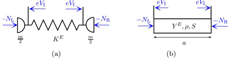
Figure 9: Modélisation de la partie mécanique du problème couplé: (a) Modèle discret. (b) Modèle homogénéisé.
