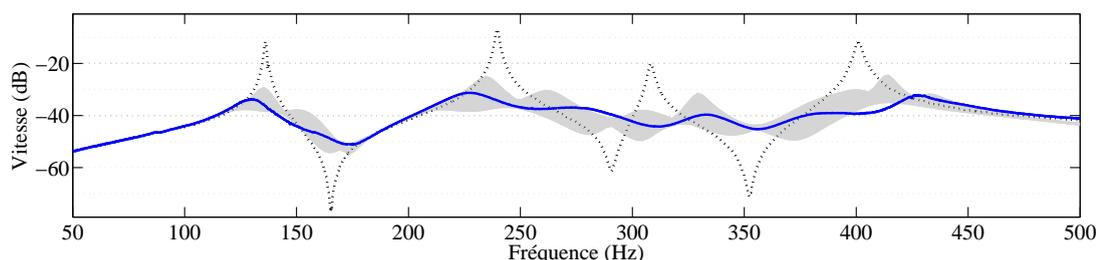
Figure 23: Influence de la valeur des inductances sur l'amortissement vibratoire - ( $\cdots$ ) réponse expérimentale en court-circuit, ( $—$ ) réponse expérimentale avec le réseau analogue pour  $L = 0.7$  H et  $R_s^+ = 180$   $\Omega$ , ( $\blacksquare$ ) simulation d'une variation de  $\pm 30\%$  sur  $L$ .
