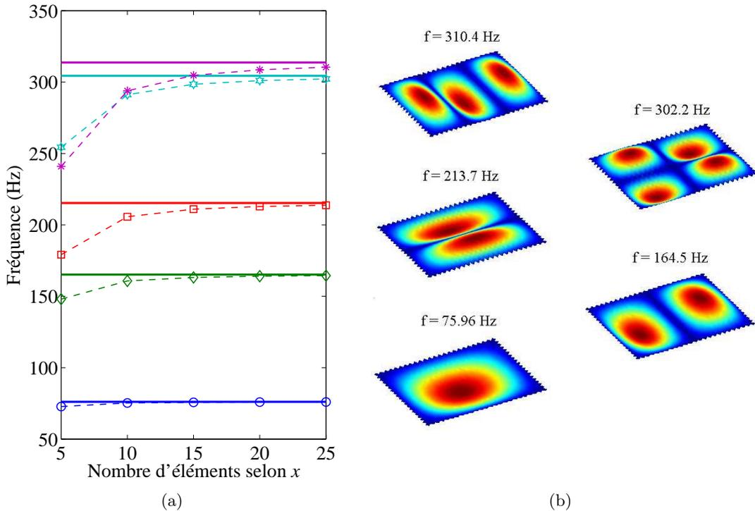
Figure 18: Analyse modale d'un réseau électrique analogue: (a) Convergence vers les fréquences propres théoriques. (b) Distributions de courant pour un réseau constitué de  $25 \times 20$  cellules élémentaires.
