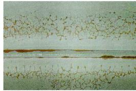
**FIGURE 2:** Fissure principale et réseaux de fissures observés par ressuage autour d'un cordon de soudure [Cipièrre et Le Duff, 2002].
