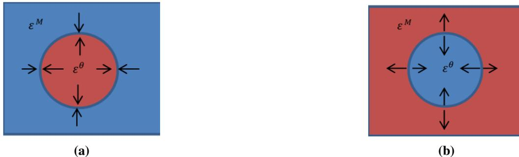
**FIGURE 3:** Surface subissant (a) un choc chaud et (b) un choc froid.
