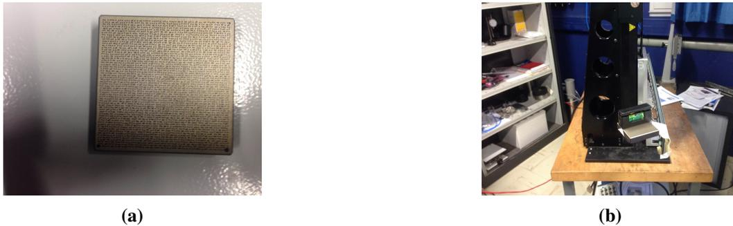
**FIGURE 2.50:** (a) Mire d'étalonnage 2D positionnée (b) sur la platine.
