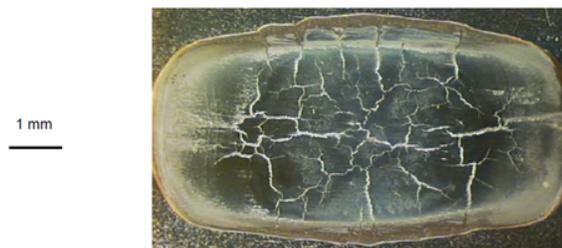
**FIGURE 5:** Faïençage thermique observé par [Maillot, 2003] à l'aide des essais SPLASH.
