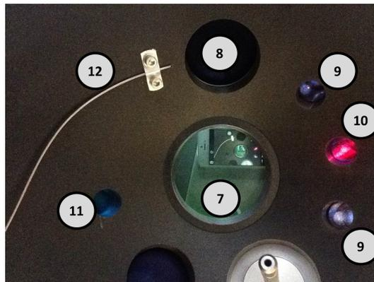
**FIGURE 19:** Vue sur la paroi interne de l'enceinte de FLASH avec les filtres indiquant la position des outils de mesure.
