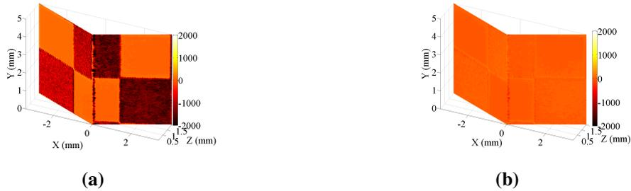
**FIGURE 2.49:** Les résidus obtenus (a) avant et (b) après correction des niveaux de gris pendant la phase d'étalonnage.
