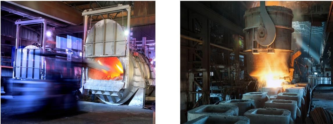
FIGURE 1 – Fusion des métaux dans le four et versement du métal liquide dans le moule.
