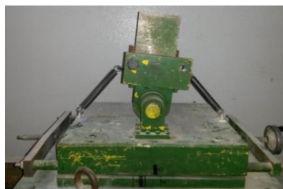
(d) Support C: Roller support.
