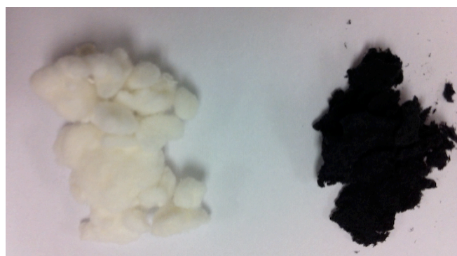
Figure 6.17 Pâte propargylée avant (à gauche) et après (à droite) greffage de la polyaniline azidée dopée
