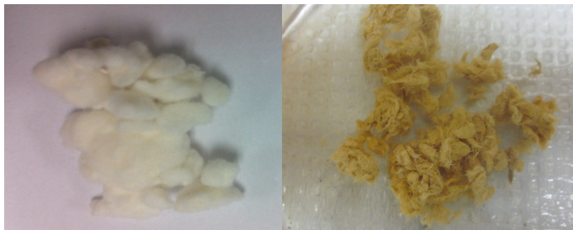
Figure 6.28 Pâte propargylée avant greffage (à gauche) et après greffage de P1 azidé dopé (à droite)
