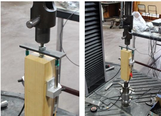
Tests et instrumentation d'éprouvettes mono-tiges
