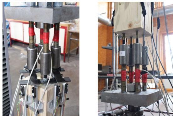
Figure IV-18 : Instrumentation des tiges de l'assemblage
