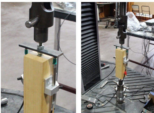
Tests et instrumentation d'éprouvettes mono-tiges
