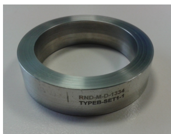
FIGURE 2.13 – Virole ondulée obtenue à l'issue de la découpe
