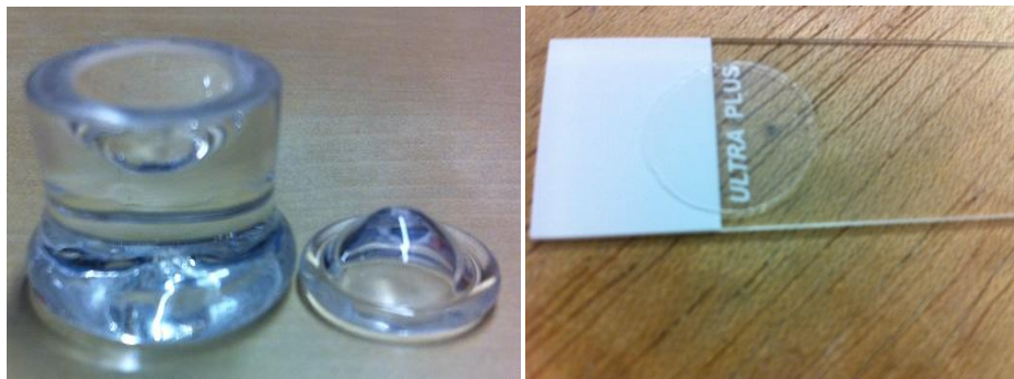
Figure 2-3 (a) moule en verre respectant la courbure de la cornée; (b) cornée moulée en forme de disque, classiquement utilisée pour les mesures de transparence et la culture cellulaire.
